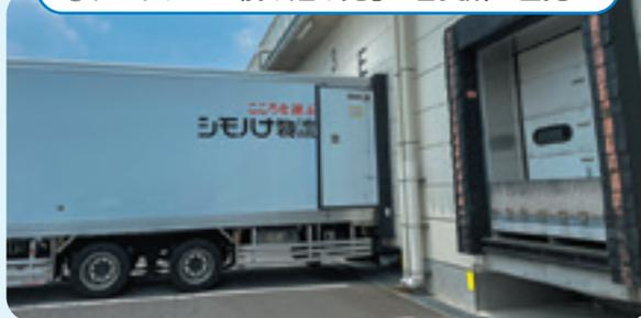
トラックの後ろが出荷口にちょうどはまる形になっていて、温度変化なく冷蔵室から冷蔵車のトラックに積み込まれます。各支所に納品された商品は生協トラックに積み込まれ、組合員のみなさまのもとへお届けします。
