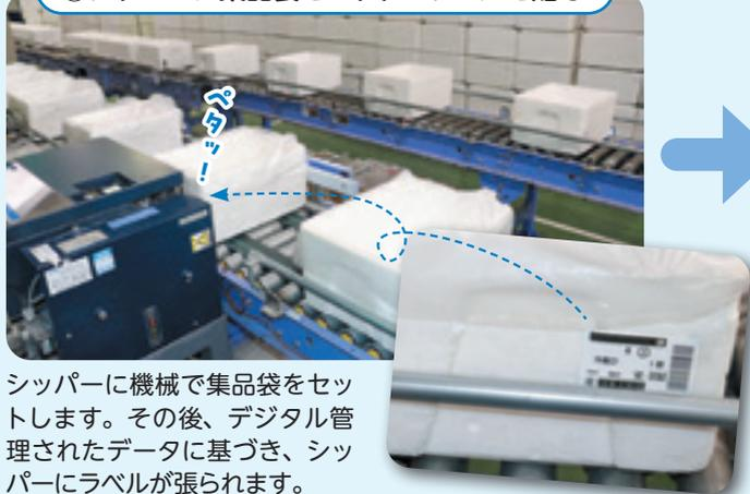
シッパーに機械で集品袋をセットします。その後、デジタル管理されたデータに基づき、シッパーにラベルが張られます。
